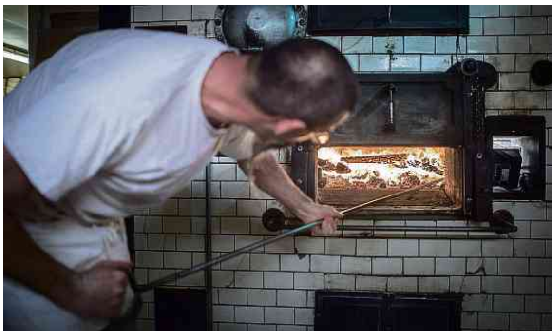
Der Ofen wird für jeden «Schuss» neu gefeuert. Das Brot wird mit der gespeicherten Energie in den Steinen gebacken.
